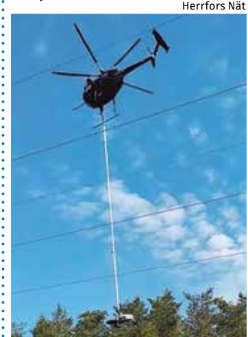
Alueverkon reunapuiden raivaus sujuu kätevimmin helikopterilla.
