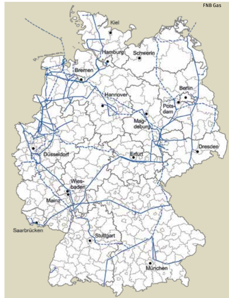
Det tilltänkta vätgasnätet för Tyskland år 2032 presenteras så här. Helderagen linje: Naturgasledningar som byggs om. Streckad linje: Nybyggda vätgasledningar.
